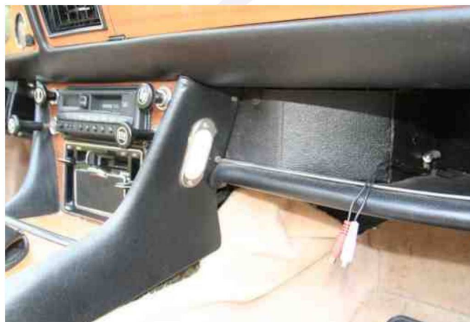
Na een kwartiertje werk is dit het resultaat: de MP3-speler op de beide kabeltjes aansluiten, en de radio op FM89,9 zetten, en u bent (onzichtbaar) weer van van alle moderne audio gemakken voorzien.
